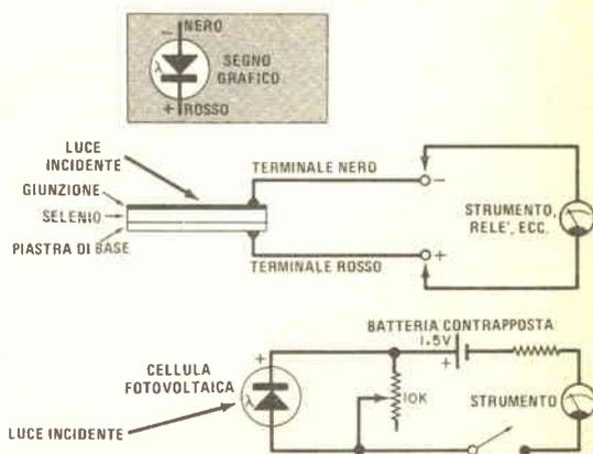
*Fig. 1 - Una cellula fotovoltaica autogenerante può azionare uno strumento od un relé di bassa potenza. Con una corrente contrapposta, ottenuta mediante una batteria ed un potenziometro (particolare in basso), il circuito ha un azzeramento artificiale in condizioni di riposo per una stabilità ed una sensibilità migliori.*
