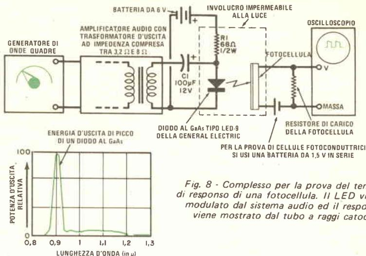
Fig. 8 - Complesso per la prova del tempo di responso di una fotocellula. Il LED viene modulato dal sistema audio ed il responso viene mostrato dal tubo a raggi catodici.
