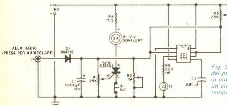
Fig. 3 - Versione modificata del previsore di temporali, in cui viene impiegato un circuito integrato temporizzatore 555.
