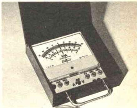
strumento tipico a cui l'elettrauto ricorre ogniqualvolta si debba ricercare un guasto e controllare i circuiti elettrici di un autoveicolo.
