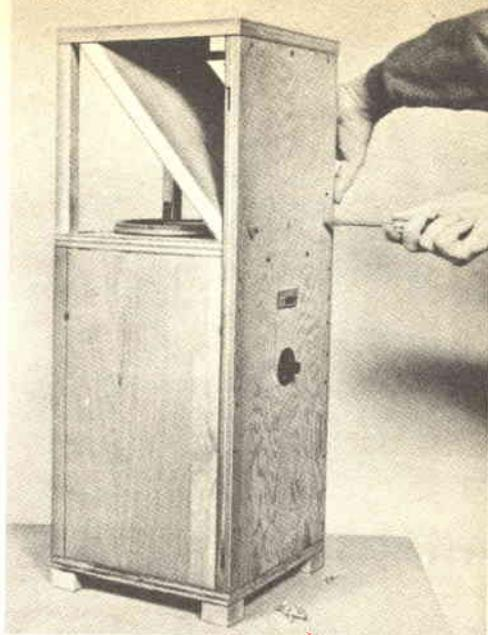
*Fig. 6 - Il pannello superiore ed il riflettore devono essere fissati unicamente con viti, senza fare uso di colla, per consentire l'accesso in futuro.*
