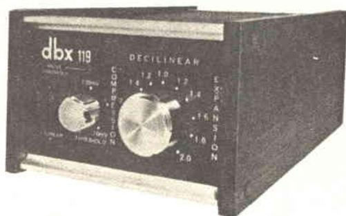
L'estensore della gamma dinamica Modello 119 della dbx è un compressore-espansore audio che impiega un vero rivelatore efficace e due elementi a basso rumore e guadagno variabile per lo stereo. La caratteristica entrata-uscita può essere regolata con continuità per ottenere una pendenza positiva maggiore dell'unità per l'espansione e poi, passando per lo zero, una pendenza inferiore all'unità per la compressione.
