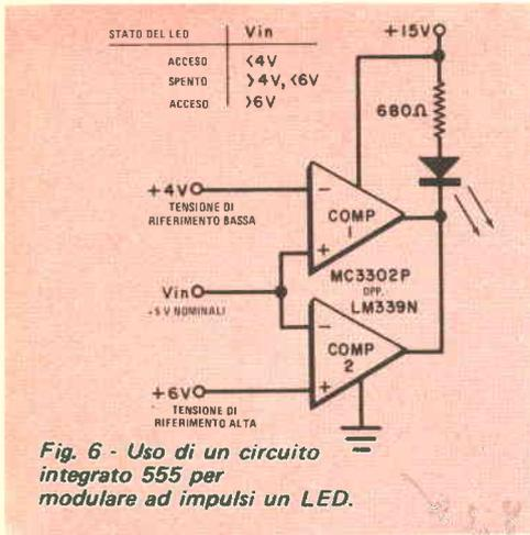
senso diretto varia tra 1,6 V e 3 V, secondo il tipo di LED, e può essere rilevata consultando le tabelle delle caratteristiche. Per esempio, supponiamo che il LED richieda 20 mA, abbia una  $V_f$  di 1,6 e che la tensione di alimentazione sia di 5 V. Allora:  $R1 = (5 - 1,6)/0,02 = 170 \Omega$ . Il valore di 180  $\Omega$  sarebbe quello standard piú prossimo; si faccia attenzione alla dissipazione del resistore, in quanto questo dissiperà la maggior parte della tensione di alimentazione.
