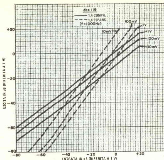
quale l'apparecchio ha guadagno pari all'unità. Quindi, il primo controllo varia la pendenza della caratteristica entrata-uscita, mentre il secondo controllo sposta tutta la caratteristica entro una vasta gamma di livelli di tensione. L'unico altro controllo è il commutatore di "Modo". Nella posizione lineare di questo commutatore, il funzionamento è come abbiamo descritto.
