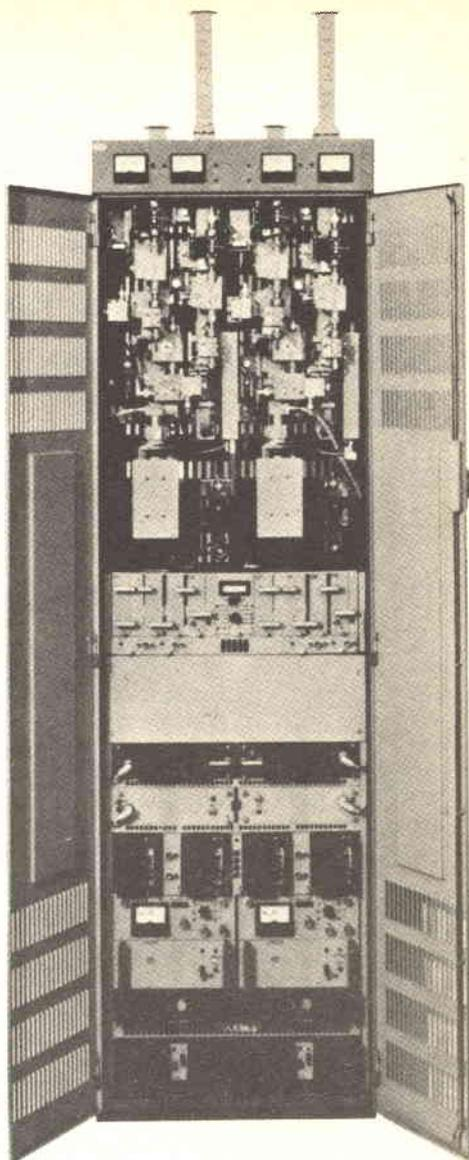
Inoltre, i circuiti dell'oscillatore locale di trasmissione e di ricezione sono dotati di un dispositivo per il controllo automatico di livello, tramite il quale viene mantenuto costante, entro  $\pm 0,5$  dB tra  $5^\circ\text{C}$  e  $45^\circ\text{C}$ , il livello d'uscita dei circuiti stessi.
