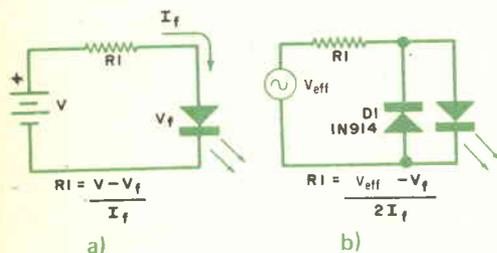
*Fig. 4 - Calcolo del resistore limitatore di corrente in serie: a) per la corrente continua; b) per la corrente alternata.*
