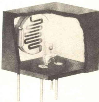
Fig. 4 - Cellula fotoconduttrice e lampadina in involucro impermeabile alla luce della National Semiconductor.
