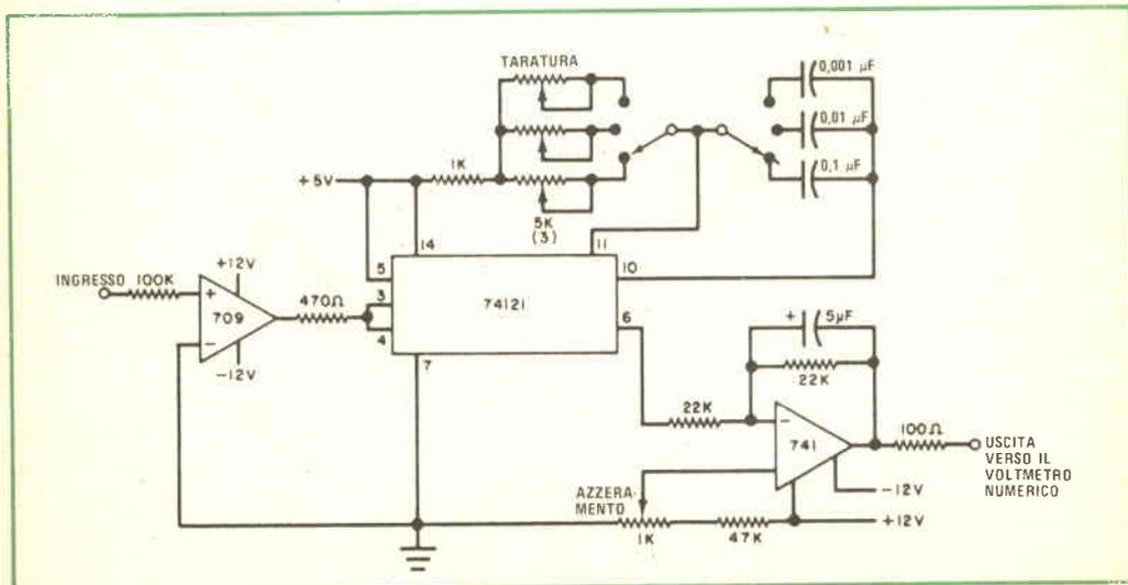
riesce a funzionare sarebbe piú bassa. Invece del 709 si potrebbe anche usare il circuito tipico di ingresso dei contatori di frequenza, cioè un transistoro ad effetto di campo ed un circuito a soglia (trigger di Schmitt). In effetti, tutto quello che è necessario ottenere da questo primo stadio è una impedenza di ingresso sufficientemente alta e la capacità di squadrare il segnale di ingresso, qualunque sia la sua frequenza.
