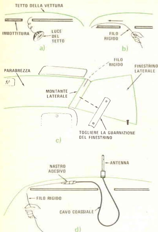
*Per effettuare l'installazione di un'antenna sul tetto di una vettura, si smonti la luce disposta sul tetto (a), si faccia passare sotto l'imbottitura un filo piuttosto rigido attraverso il foro fino ad un montante laterale (b) e (c), si pratichi il foro sul tetto della vettura, si fissi l'antenna e si faccia passare il cavo coassiale sotto l'imbottitura con l'aiuto del filo rigido fatto scorrere precedentemente (d).*
