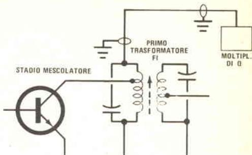
*Fig. 3 - Schema del collegamento con cavo coassiale tra il ricevitore ed il moltiplicatore di Q.*
