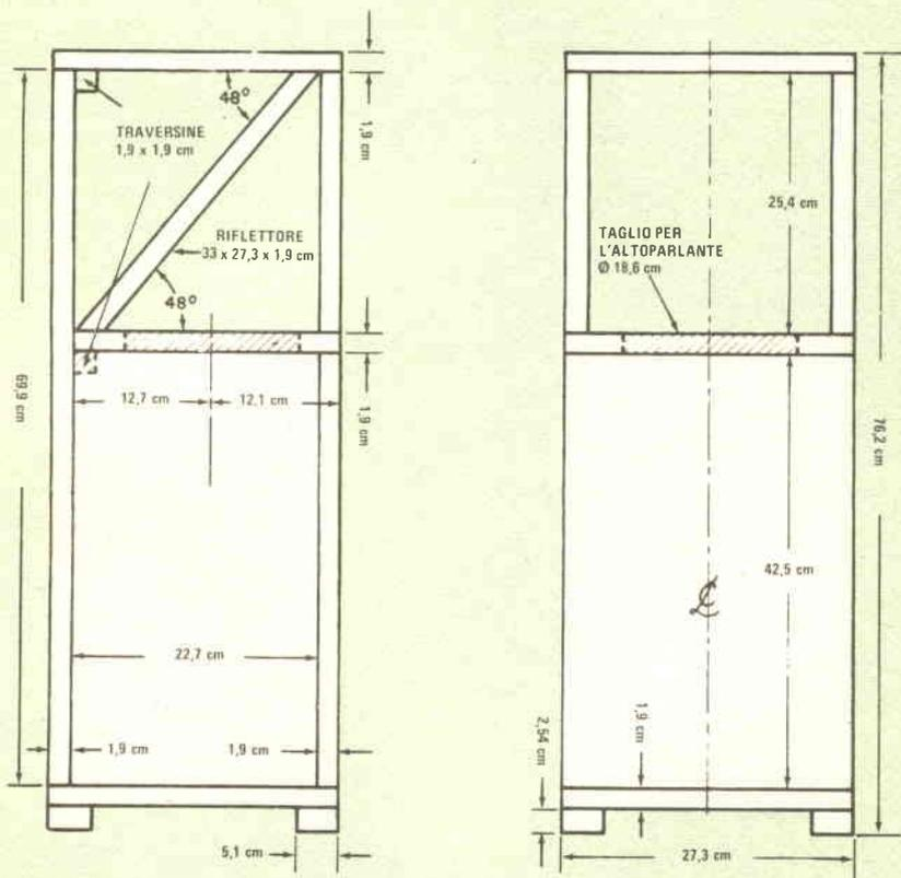
Fig. 1 - In questo disegno sono illustrati i sistemi per mettere insieme il mobile ed i particolari del riflettore.
