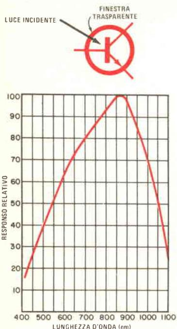
Fig. 3 - Il responso spettrale del fototransistore al silicio è molto ampio e rapido. Nel dispositivo è incorporato uno stadio di amplificazione.
