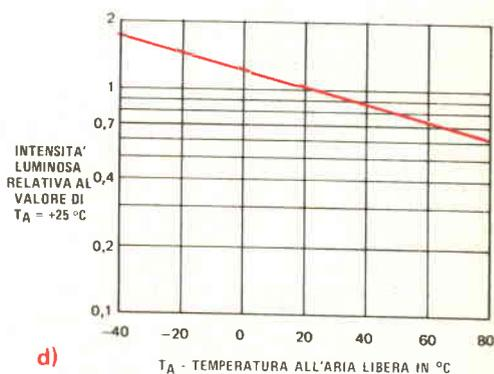
Fig. 3 - Luminosità (a) e tensione (b) in funzione della corrente per unità tipo 100 della Fairchild. Intensità per varie lenti (c) (Monsanto MV5020). Intensità in funzione della temperatura per il TIL209A della Texas Instruments (d).
