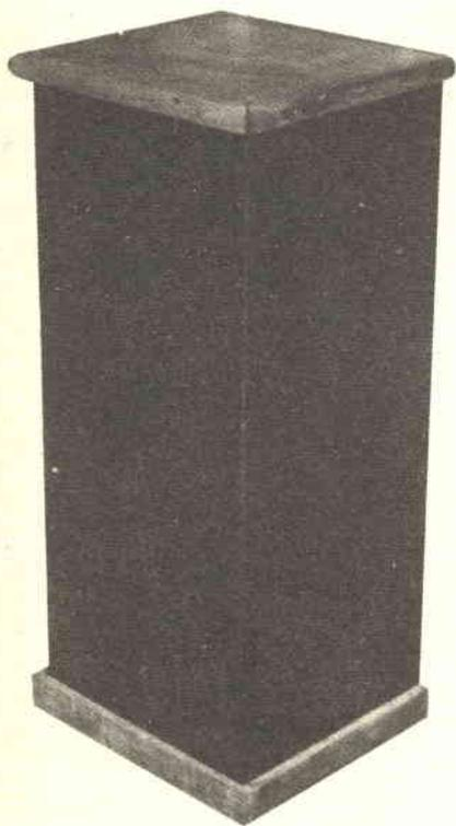
*Per rifinire l'insieme, si fissa un pezzo di stoffa tutto intorno al mobile. La guarnizione inferiore non deve arrivare fino al pavimento, ma essere contenuta al livello del pannello inferiore.*
